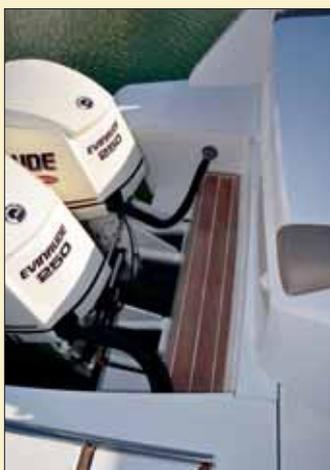
Aunque esta unidad se monta con dos motores fueraborda, se ha conseguido mantener la práctica totalidad de la apreciada plataforma de baño de la versión dentro fueraborda.
