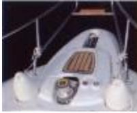
En el pronunciado balcón de proa abierto se ha dispuesto una pequeña superficie de teca y un escalón para facilitar el desembarque por proa. La completa maniobra de fondeo está compuesta por un molinete eléctrico de 700 W con ancla y cadena perfectamente ubicada en su cofre, flanqueado por dos originales huecos portadefensas a cada uno de los lados.
